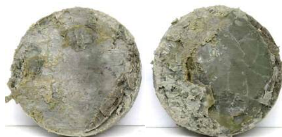
写真-1 コアに確認された凹凸に富む鏡肌状せん断面
