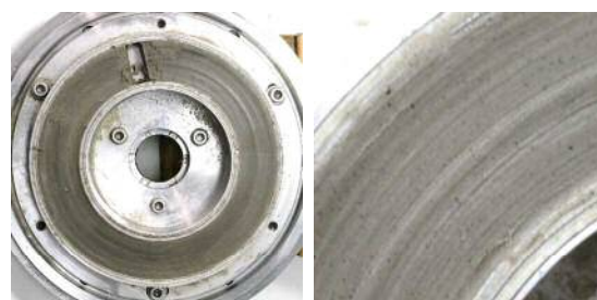
写真-2 リングせん断試験による残留強度状態のせん断面
