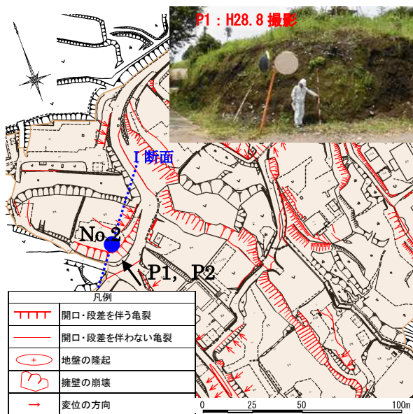
図-1 被災盛土造成地の平面図(A 地区)
