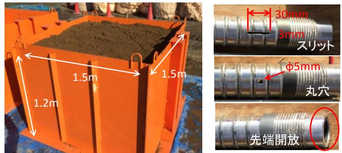
図1 鋼製土槽
