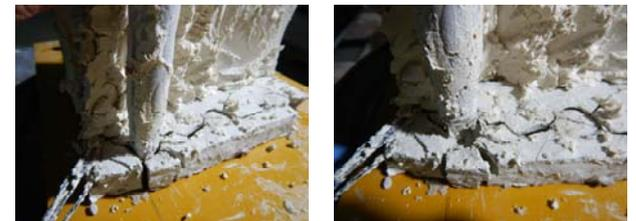
写真-2 パンチング破壊状況 (ケース 4)
