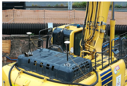
写真 1 GNSS 装着状況(左：基地局, 右：受信機)
