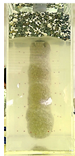
写真-2 改良体の可視 化状況
