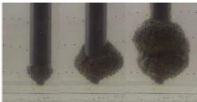
写真-1 圧入時のモルタル改良体の拡径状況
