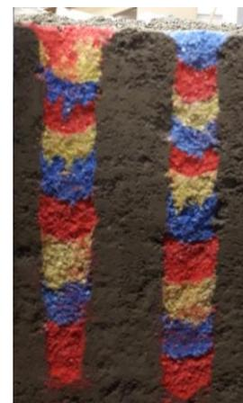
写真-2 水平載荷後の碎石パイルの断面図
