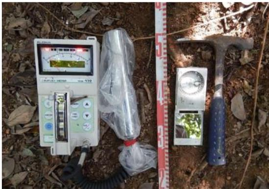
写真1 γ線計測装置 (シンチレーションサーベイメータ)
