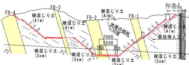
図4 切土法面工計画断面における対策設計
