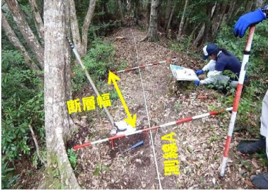
写真2 測線Aにおけるγ線調査状況
