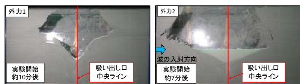
図-6 空洞陥没後の地盤の写真
