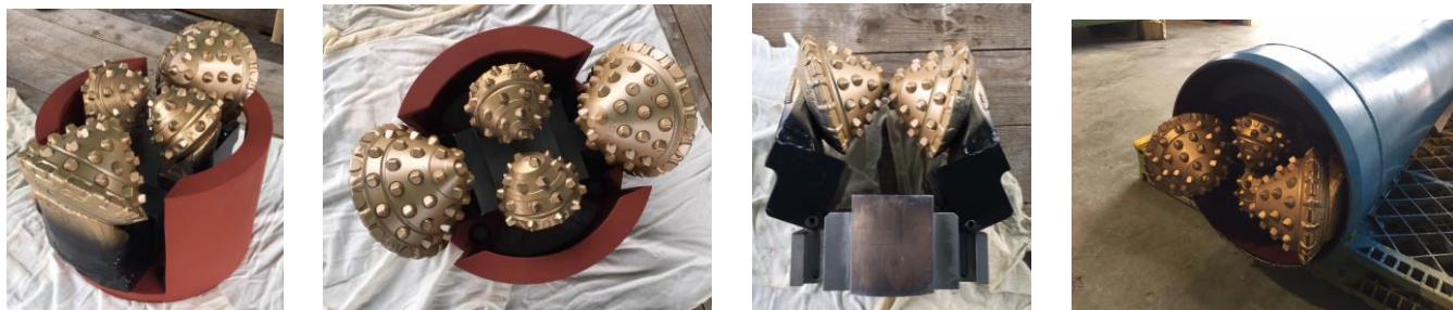
写真-1 進機先端のカッター伸縮格納の確認状況
