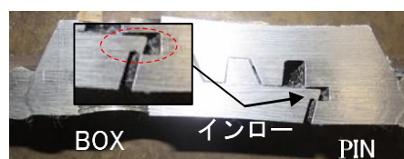
図10 試験後の継手下端断面
