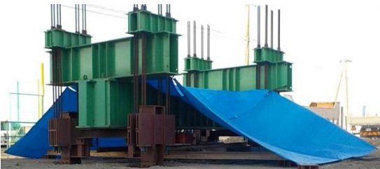
写真 3 載荷試験装置
