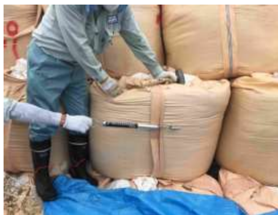
写真-1 水平抵抗力計測状況 (L 型アンカー)
