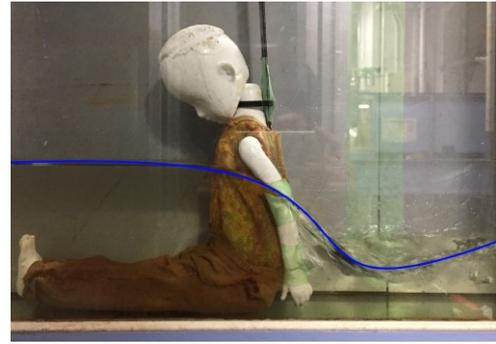
写真-1 狭い側溝(B=0.40m)での水深せき上げ
