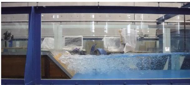
図-1 潜り込み流れの流況
