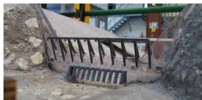
(b) 改良型砂防堰堤
