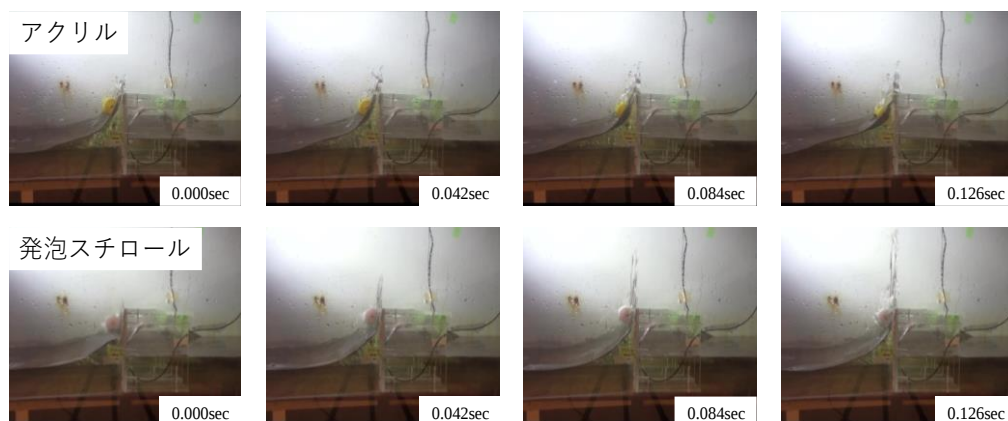
図-4 波が護岸に作用する様子
