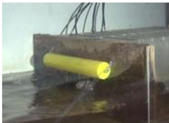
図-1 簡易越波対策工
