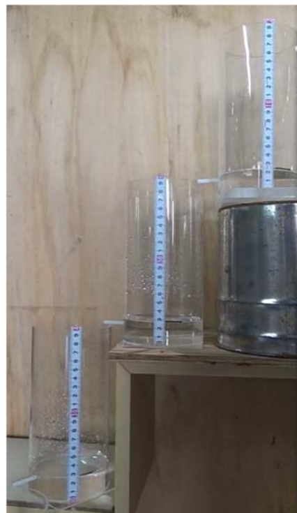
図-3 漏刻の水理実験装置
