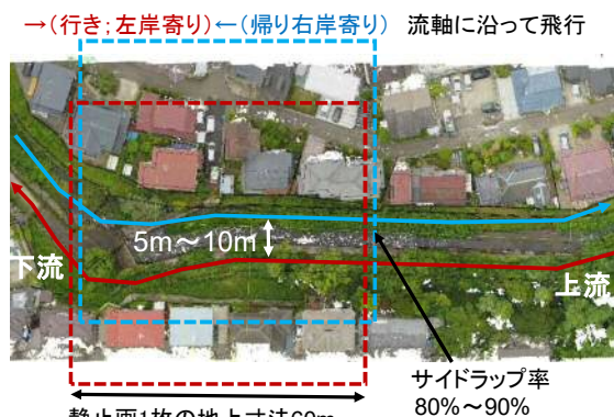
図-1 UAV写真撮影の飛行ルート (平面図)
