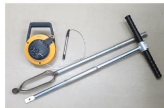
図-4 水位計(左)と掘削器(右)
