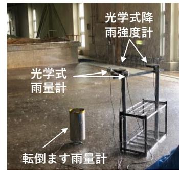
写真-1 人工降雨実験の様子
