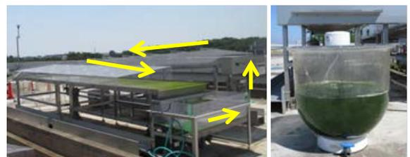
写真1 薄層液体培養槽
