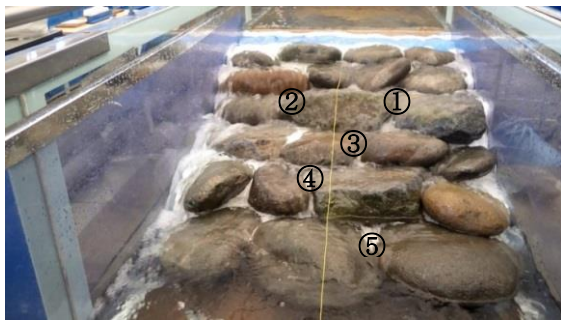
写真2 千鳥を再現した練積み魚道における流速測定のポイント（①～⑤で示す）
