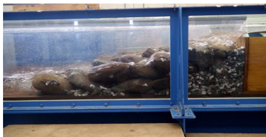
写真3 平石魚道内の流況( h_c=3.3\text{cm} )
