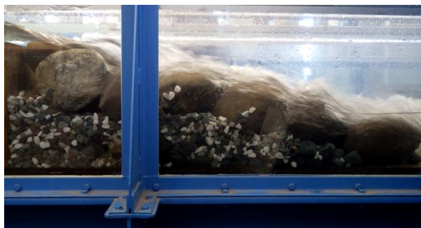
写真6 丸石の流況( h_c=6.6\text{cm} )
