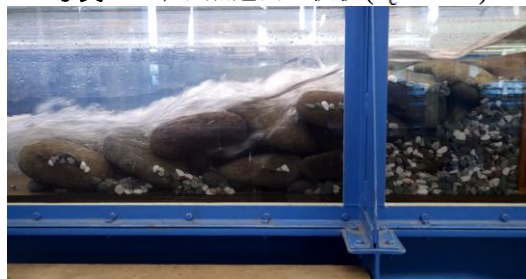
写真4 平石魚道内の流況( h_c=6.6\text{cm} )
