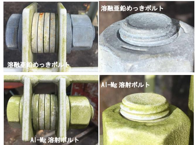
図-5 亜鉛めっき / Al-Mg 溶射ボルト (3年後)
