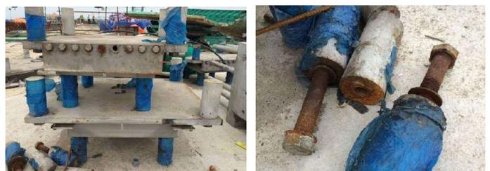
(b) 溶射による防錆 (施工品質) が十分ではない例
