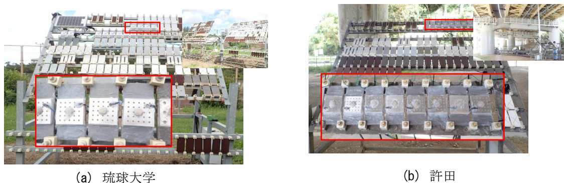
図-2 大気暴露試験の状況
