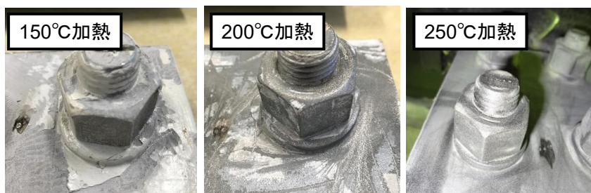
図-2 塗膜剥離状況
