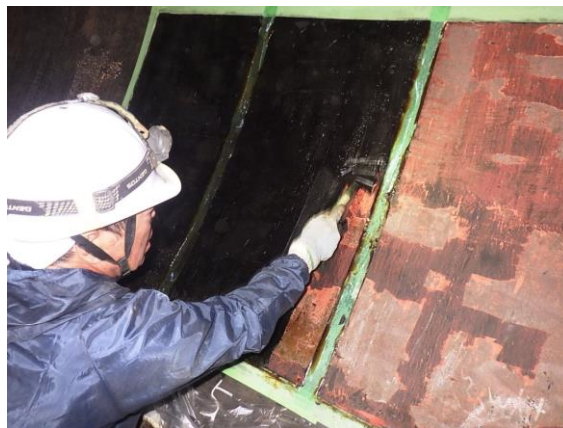
図 1 A 水圧鉄管の剥離状況の例（No.③, 48h） 塗膜厚 ( \mu\text{m} )
