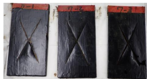
図 6 塗膜の剥離状況
