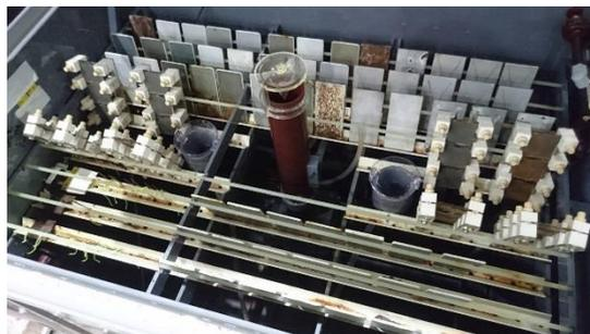
図-1 複合サイクル試験機の槽内の様子
