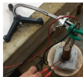
写真-5 現場を想定した抵抗計測の様子
