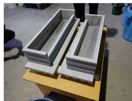
写真-4 止水性評価試験体
