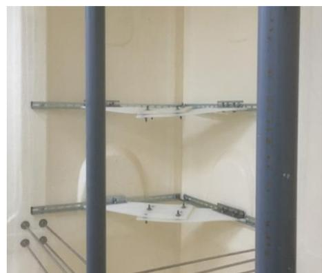
写真-4 バルジング用制振装置
