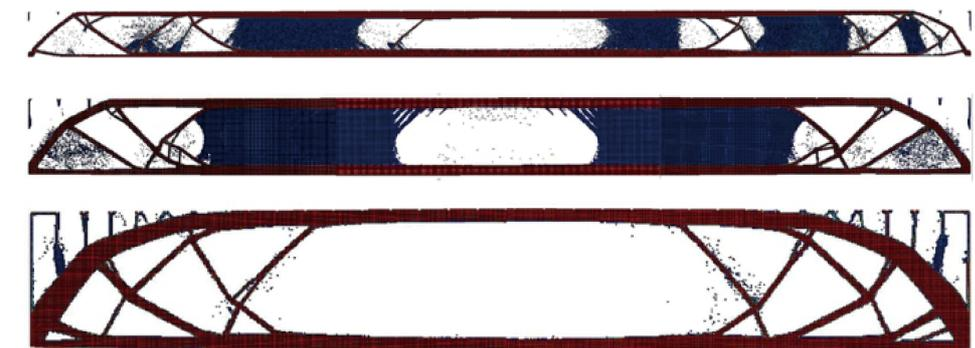
図3 設計領域高さ 1.5m 2.5m 5m での最適化結果
