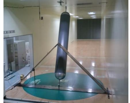
図 1 斜円柱模型設置状況
