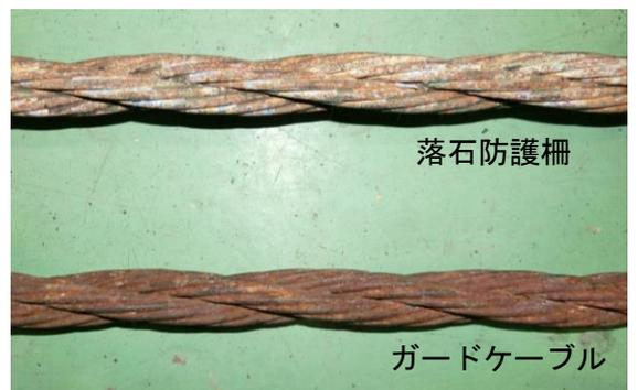
写真-3 試験体表面の状況
