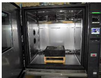
図2 内部温度計測用ダミー支承
