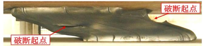
(試験条件 面圧 6MPa, 変位速度 2mm/sec, 破断ひずみ 520%)
