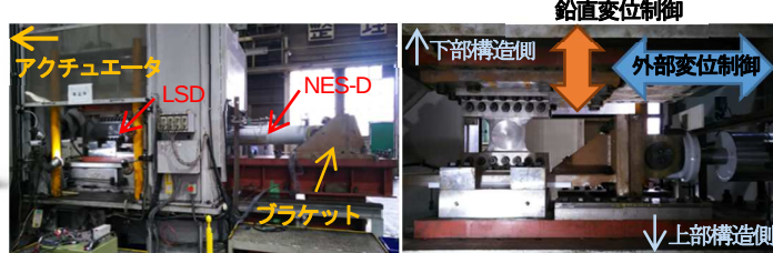
(a) 荷重装置への設置状況 (b) NES-DとLSDの接合部
