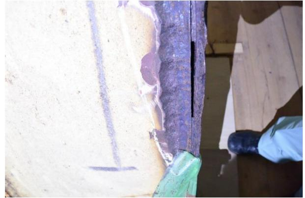
写真-1 すみ肉溶接部の腐食切れの一例
