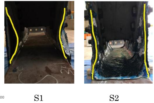
図4 ガセット面外変形状況
