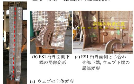
図-6 荷重試験後の ES1 周辺の変形状況
