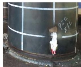
写真-1 橋脚基部の局部座屈変形
