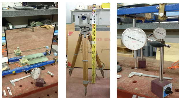
図-3 計測装置（鏡、望遠鏡と標尺、変位計）
