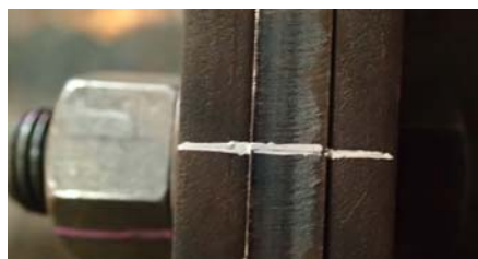
写真 1 試験後ボルト状況
