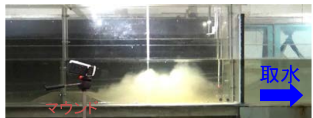
写真-1 取水口前面における浮遊砂の状況
