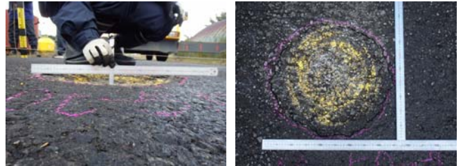
写真-2 計測状況(重錘質量 1.0t、高さ 5m 落下)
