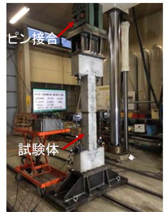
図 2 RC 試験体の荷状況
