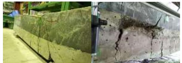
図 1 各梁の破壊状況（左：2 層，右：3 層）
