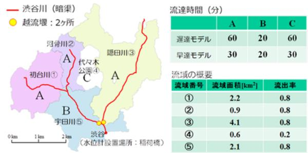
図-3 解析に用いた流域モデルと入力情報
